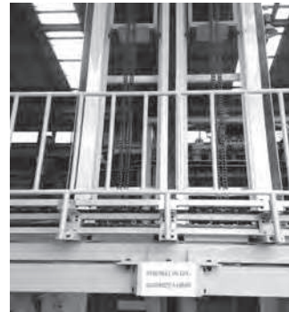
K자동차회사의 D/L에 슈퍼체인 使用 例 An example that K motor company uses Super Chain on D/L
